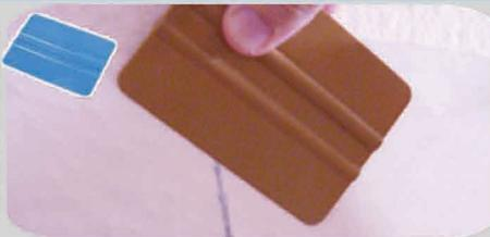
Klappen Sie die Übertragungsfolie ein Stück zurück und streichen erneut mit etwas mehr Druck über diese Stelle.
